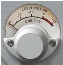
Il Modulometro Nagra viene ereditato dal secondo registratore sviluppato dalla Nagra nel 1952, il Nagra II. Il Modulometro è un tipico strumento di precisione Nagra che visualizza le informazioni necessarie per effettuare la migliore registrazione possibile. Nel caso del JAZZ il Modulometro visualizza il livello di uscita. 0 dB corrisponde ad un segnale di 1 V rms in uscita. Canale sinistro: ago rosso. Canale destro-ago verde
